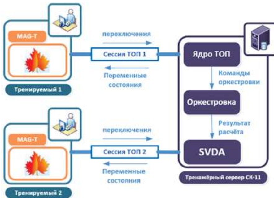
Архитектура проведения локальной тренировки по переключениям
